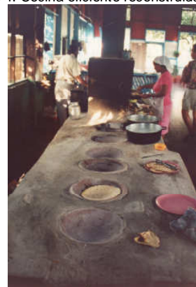
Foto 4. Cocina eficiente reconstruida
